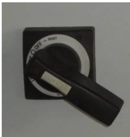
Figura 5-2: Comutator principal în poziția "OFF"
